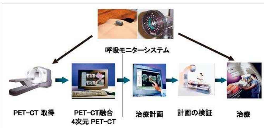
写真3：PET-CTと呼吸モニターシステムを統合した高精度放射線治療システム
