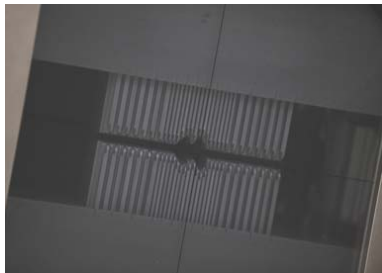
「Novalis Tx」のMLC。中央部は世界最薄の2.5mm幅のマイクロMLCを採用、22×40cmの広い照射野をカバー
